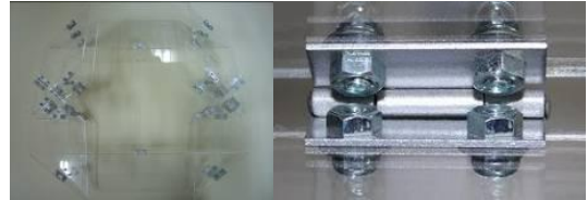
Fig.4. モデル 1 の製作品(左)ヒンジ部の干渉(右)
