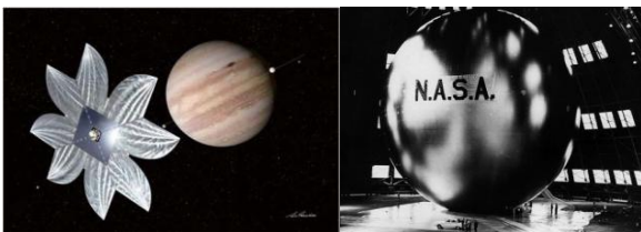
Fig.1.1 ゴッサマー構造物の代表例 (左図:木星セイル, 右図:受動型通信衛星 ECHO)
