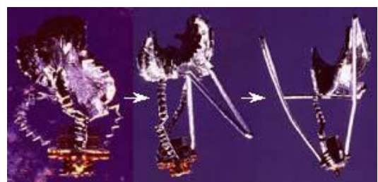
Fig.2.1 Inflatable Antenna 展開の様子
