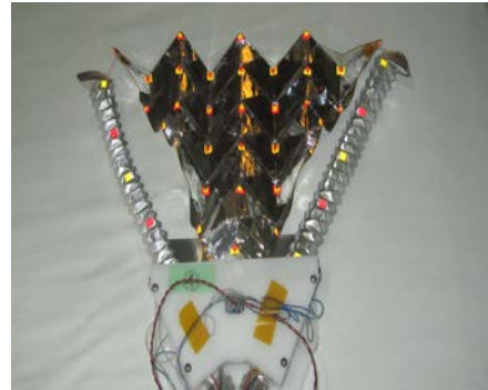
Fig.7. インフレータブルチューブおよび膜面
