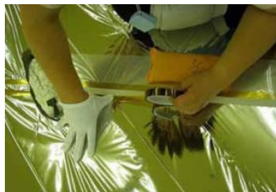
Fig.2 IKAROS の膜面製作 (補強テープの貼り付け)
