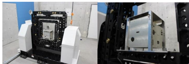
Fig. 9 3軸回転台を用いた試験
